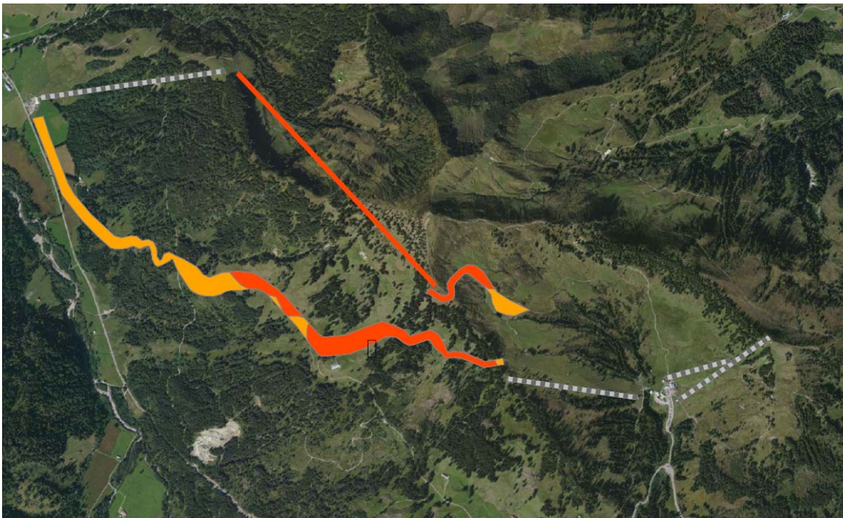
Abb. 2: Neuerschließungen des Teilflächennutzungsplans im Bereich Grasgehren / Riedberger Horn. Rot – Lage innerhalb Alpenplan Zone C, orange – Lage innerhalb Alpenplan Zone B. Rote Linie – SO-Kabinenseilbahn, Flächen (rot/orange): Neuerschließung Pisten. Grau gestrichelte Linien – bestehende Lifte.
