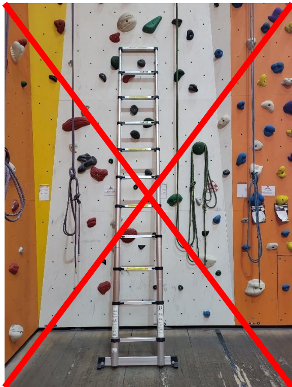
Abb. 9: Teleskopleitern des Typs Sprossenleiter sind für Arbeiten auf Leitern nicht mehr zulässig!
