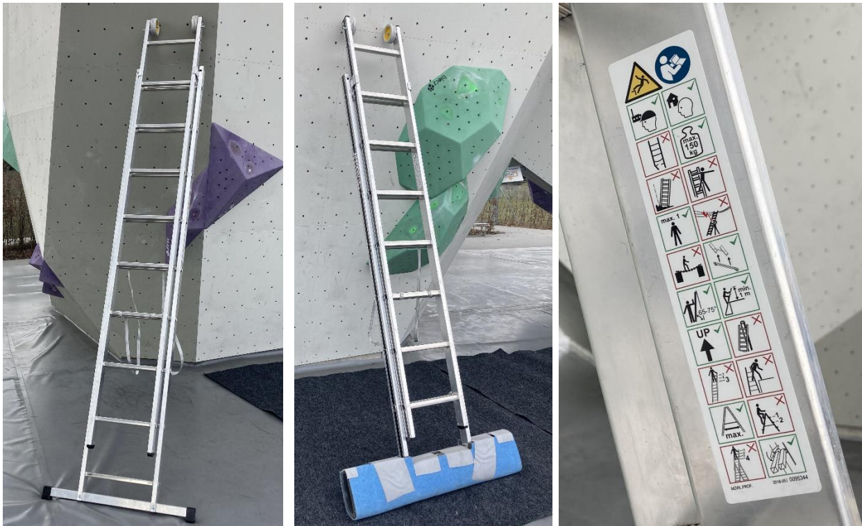
Abb. 16: Mehrzweckleiter mit Traverse für Mattenuntergrund, Quertraverse mit abgepolsterter Traverse für besseren Halt auf Schutzteppich und Rollen am Leiterkopf; Piktogramm Mehrzweckleiter
