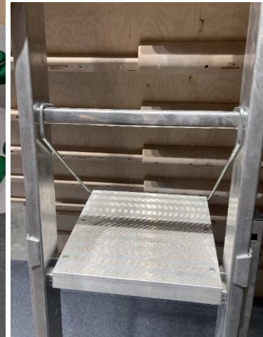
Abb. 5: Dreiteilige Sprossenschiebeleiter; Einsatz nur mit Einhängestufe oder -podest
