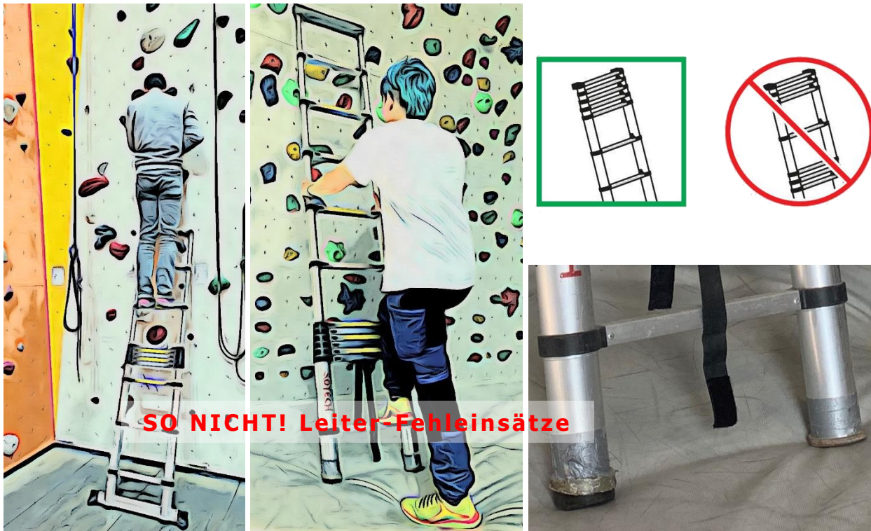
Abb. 8: Fehleinsatz Teleskopleiter: Stufenauszug falsch (Blockbildung nicht oben); keine Traverse und falscher Stufenauszug; nicht sachgemäße Leiterfuß-Reparatur
