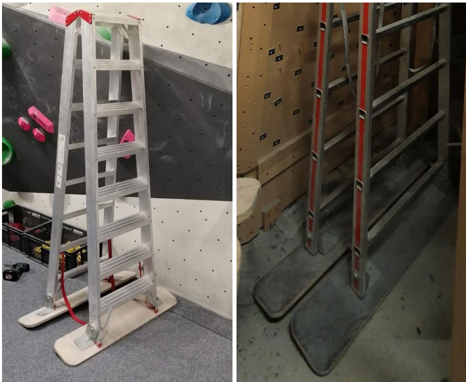
Abb. 17: Traversen bzw. Stand-Verbreiterungen an Stehleitern für den Einsatz auf Matten
