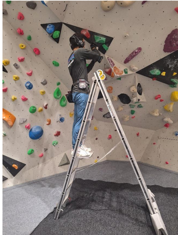
Abb. 12: Mehrzweckleiter mit Sprossen Einsatz als Schiebeleiter/Anlegeleiter und als Stehleiter möglich; Nutzung nur mit Einhängestufe oder -podest
