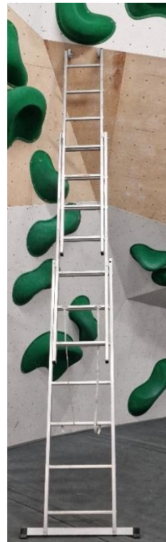
Abb. 5: Dreiteilige Sprossenschiebeleiter; Einsatz nur mit Einhängestufe oder -podest
