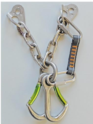
Foto 2: Beispiel für eine vorübergehende behelfsmäßige Hintersicherung.
