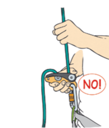
Abb. 5: Wer bei Geräten der „Funktionsweise Grigri“ die Blockierfunktion ausschaltet und gleichzeitig gegen das Bremsandprinzip verstößt, bedroht das Leben seines Seilpartners, statt es zu sichern.
