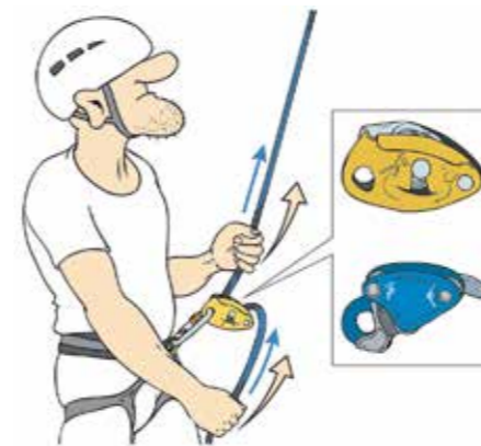
Abb. 1: Bei Geräten der „Funktionsweise Grigri“ geht das Seilausgeben prinzipiell wie beim Tube. Bei dicken Seilen und zum schnellen Ausgeben kann es schwierig werden.
