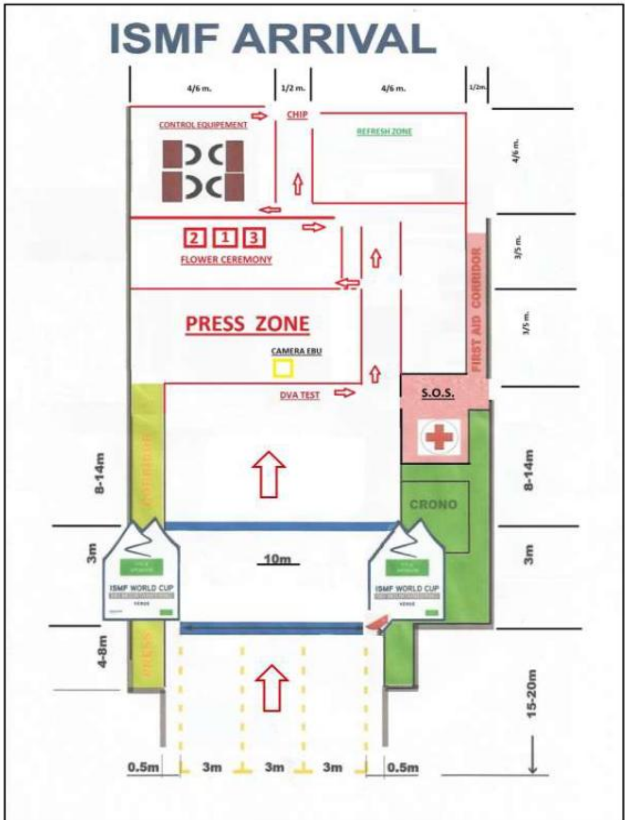
Abbildung 11 Technischer Aufbau Zielbereich laut ISMF 3
