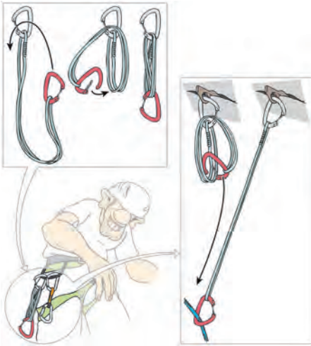
Abb. 2: Die „Alpin-Expressschlinge“ lässt sich flott verlängern, um den Seilverlauf zu begradigen.
