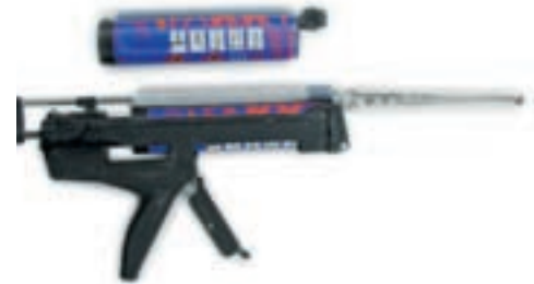
Abb. 3: Auch bei Kartuschenmörtel gilt es, Regeln zu beachten, wie z.B. den „Vorlauf zu verwerfen“.
