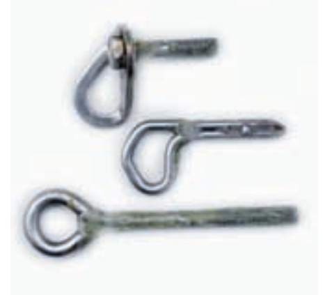
Abb. 7: Bei diesen Haken versagte der Mörtel!
