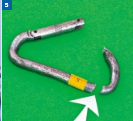
Bruchstelle eines zerrissenen Karabiners
