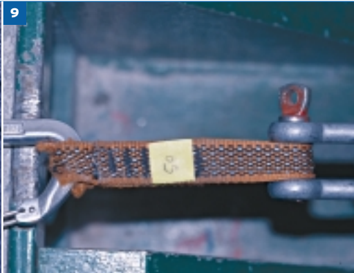
9 Diese Schlinge wäre bei einem Sturz gerissen!
