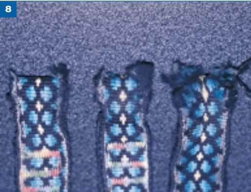
8 Starker Verschleiß durch raue Wände
