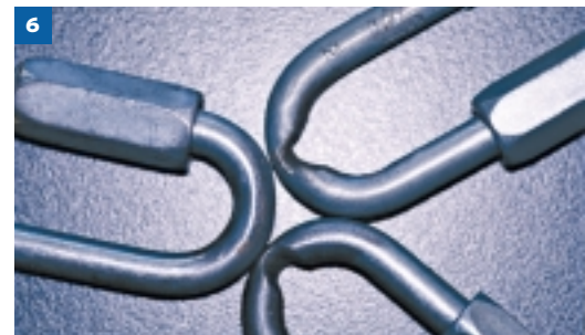
Durch Bohrhakenlaschen eingekerbte Schraubglieder
