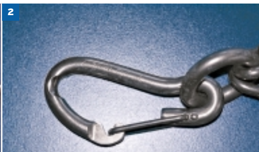
2 Obwohl eingeschliffen noch unproblematisch
