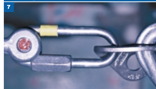
Auch die stark eingekerbten Schraubglieder hielten noch erstaunlich viel.
