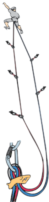
Abb. 8: Mit der Halbbeiltechnik kann die Gefahr gesenkt werden, dass Steinschlag beide Stränge gleichzeitig durchtrennt.
