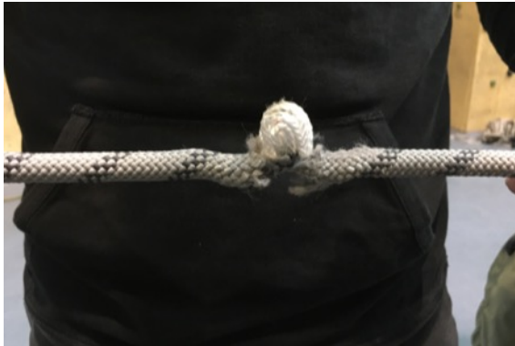
Beschädigung des Seils durch Volume
