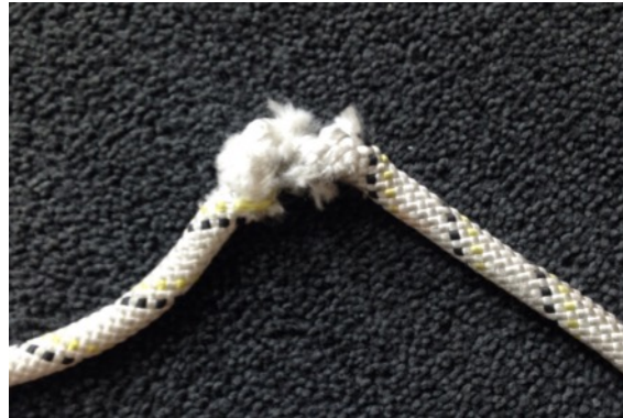
Beschädigung des Seils durch Kantenschutz
