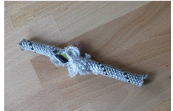
Beschädigung des Seils durch Kantenschutz
