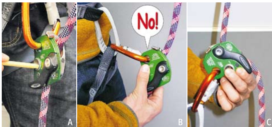
ACHTUNG! Wer's selbst versuchen möchte: In dieser Position (A) kann das Cinch nicht blockieren, selbst wenn ein deutlicher Ruck wirkt. Die Gelenkniete befindet sich unter dem Aufhängepunkt. Auch wenn in dieser Position die Bremshand das Bremsseil umfasst, kommt es nicht zum Blockieren (B). Das Seil läuft parallel zum Ablasshebel durch das Gerät, der Sichernde verbrennt sich hier die Bremshand.
