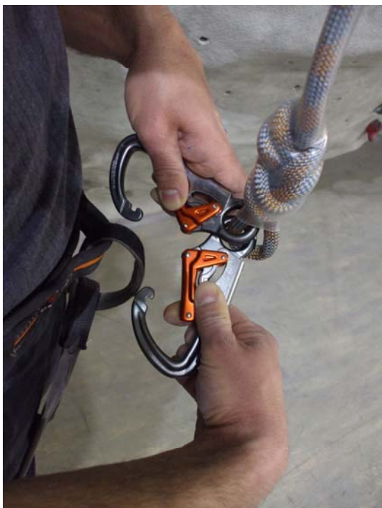
Abbildung 5: gegengleiches Einhängen der Karabiner zum Anseilen
