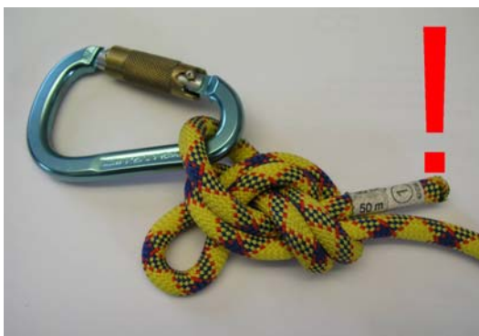
Abbildung 15: Karabiner wird in teilweise aufgezogenen Achter eingehängt.
