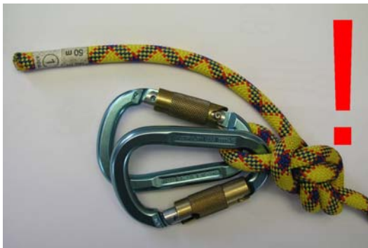
Abbildung 14: der Achterknoten ist teilweise geöffnet
