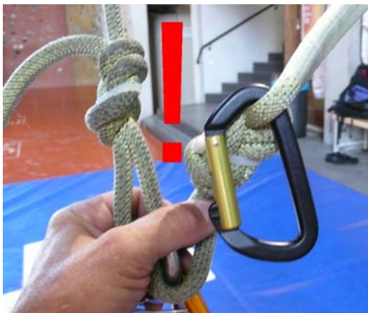
Abbildung 12: Durch den Schrumpfschlauch über dem Seil rechts bildet sich eine Schlaufe, in die fälschlich angeseilt werden kann.
