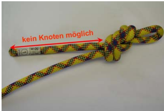
Abbildung 8: der Achterknoten ist so geknüpft, so dass kein Knoten (Sicherungsschlag) mehr nachgeschaltet werden kann.
