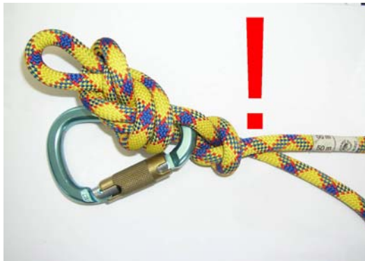
Abbildung 9: Ein Sicherungsschlag über dem Achterknoten birgt die Gefahr des falschen Einhängens!
