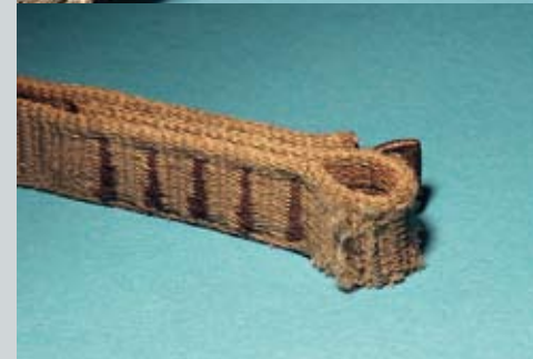
Abb. 2: Mechanische Verletzungen an Bändern und Expressschlingen mindern die Festigkeit. Hier ist durch Scheuern an der Wand eine markante Kerbe entstanden.
