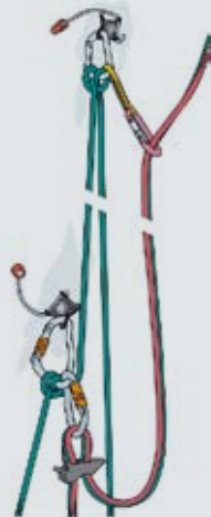
Abb. 7+8: Vorstiegssicherung mit Tube und Dummyrunner
