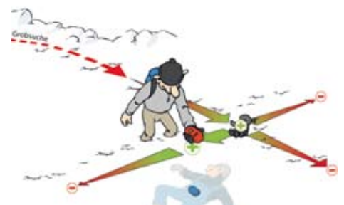
3 Feinsuche: Durch Einkreuzen ermittelt man das optimale Signal, den vermuteten Liegepunkt.
