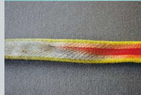
Abb. 3: Bänder altern unter UV-Strahlung stärker als Reepschnüre, weil das tragende Material nicht durch einen Mantel geschützt ist. Ausgebleichte Bänder austauschen!
