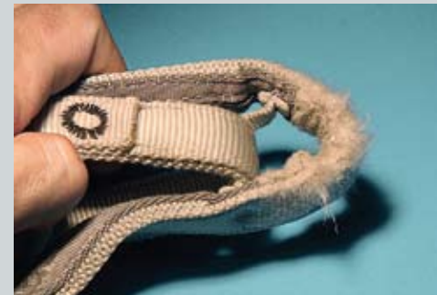
Abb. 1: Beim Klettergurt kann der Beinschlaufensteg durchs Seil oder die Einbindeschlaufe durchgescheuert werden. Protektoren können den Verschleiß vermindern.
