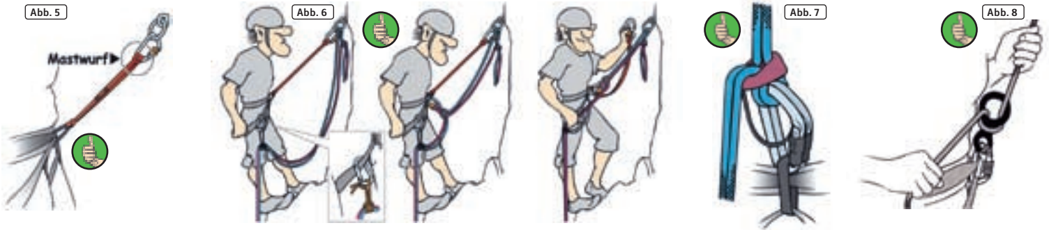
Abb. 5: So ist's sicher: Karabiner in der Selbstsicherungsschlinge mit Mastwurf fixieren. Abb. 6: Vorbereitung zum Abseilen: Kurzprusik legen; Abseilgerät einhängen; Selbstsicherung lösen; los geht's! Abb. 7: Der Tuber erlaubt komfortables Abseilen; bei Bedarf erhöht ein zweiter Karabiner die Bremswirkung. Abb. 8: Wer mit Achter abseilt, sollte ihn fixieren, damit er nicht die Verschlusshülse durchstanzen und sich aushängen kann.
