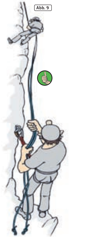
Abb. 9: Durch Zug am Seil kann der untere Partner den Abseilenden stoppen. Voraussetzung: keine Steinschlaggefahr!
