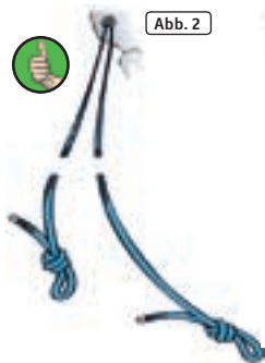
Abb. 2: Ein Sackstichknoten in jedem Seilende verhindert das „Über-die-Enden-Abseilen“. Abb. 3: Das fixierte Kräfte-dreieck verteilt die Abseilbelastung gleichmäßig auf alle Fixpunkte am Stand, so dass selbst bei Ausbruch eines Fixpunktes kein Ruck auf den anderen kommt. Abb. 4: Achtung, den Karabiner der Selbstsicherungsschlinge nicht mit Gummiband fixieren; wird die Schlinge aus Versehen mit eingehängt, klinkt sich der Karabiner bei Belastung aus.
