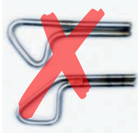
Abb. 6: Die Hakenschäfte sind zu glatt! Die Verbindung zwischen Mörtel und Haken ist sehr schlecht.
