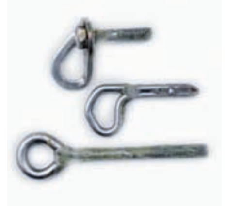
Abb. 7: Bei diesen Haken versagte der Mörtel!
