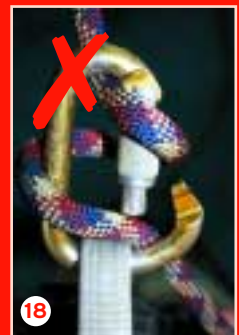
Bild 18: Karabiner dreht sich im Sicherungsring, das Bremsseil legt sich über den Verschluss und öffnet diesen.
