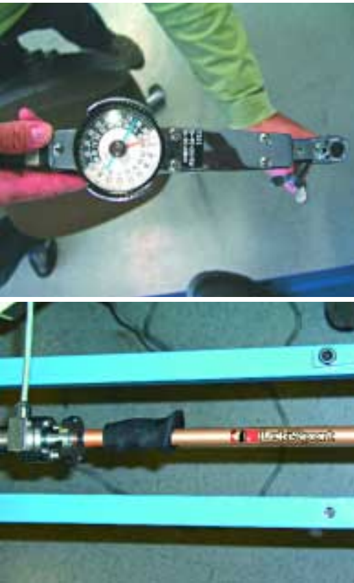
Oben: Einstellen des Drehmoments bei den Teleskopstöcken. Unten: Ermittlung der Stützkraft im Drucktest
