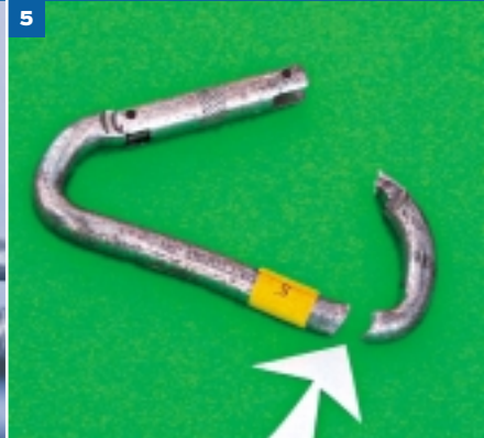
Bruchstelle eines zerrissenen Karabiners
