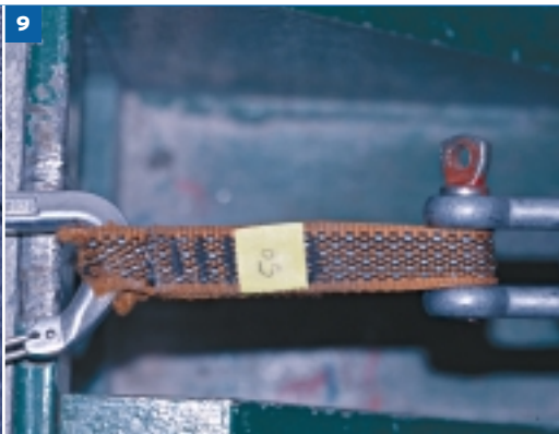
9 Diese Schlinge wäre bei einem Sturz gerissen!
