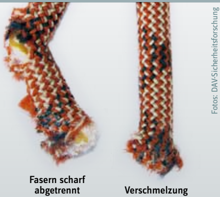
Abb. 3: So sieht ein durch Steinschlag gerissenes Seil aus: Die Fasern sind scharf durchtrennt, aber durch die Energie des Steintreffers teilweise verschmolzen.
