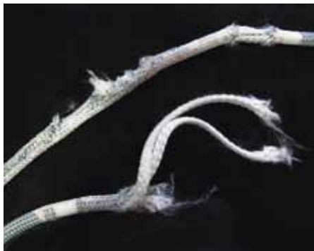
Abb. 4: Nicht neben der Autobatterie lagern! Nach Einfluss von 36-prozentiger Schwefelsäure riss dieses Seil unter quasistatischer Zugbelastung von etwa 1 Kilonewton (100 kg) statt erst bei 20 kN, wie bei einem neuen Seil.
