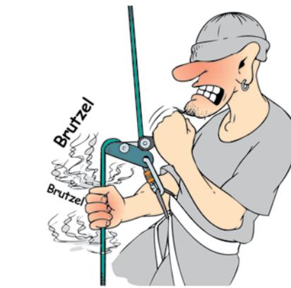
Abb. 4: Der Ablasshebel beim Grigri ist ein „Gashebel“ – wird er in Panik durchgezogen, muss die Bremshand alles halten, ein verbreiteter Unfallgrund.
