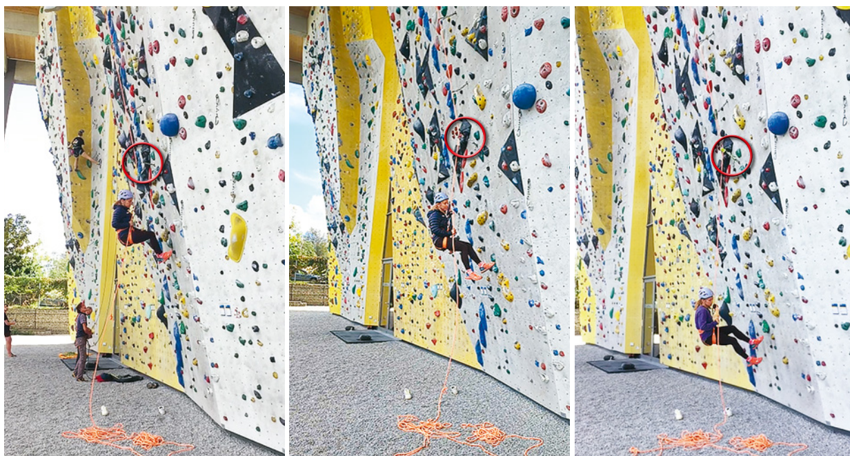
Abb. 2: Praxistests in der Kletterhalle: Gewichtsunterschied 29 kg, passives Sicherungsverhalten, Seildurchmesser 9 mm. Die unterschiedlich starke Bremswirkung der Geräte wird durch die Höhe der sichernden Person verdeutlicht. Von l. n. r.: nur mit Karabiner, Zaed Stufe 2, Ohm. Roter Kreis: eingehängte Zwischensicherung bzw. Gerät.
