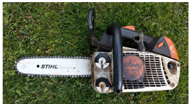
Abbildung 38: Leichte Benzin-Baumpfleugesäge für kleinere Arbeiten. Gewicht 3,1 kg. (Foto: C. Piccolruaz)
