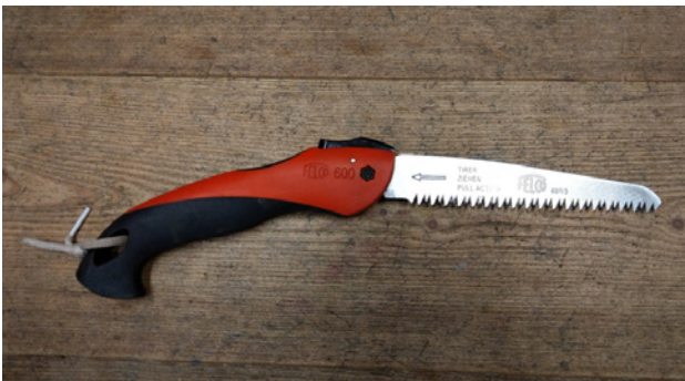
Abbildung 37: Kleine Klappsäge (Faltsäge) für ziehenden Schnitt. (Foto C. Piccolruaz)
