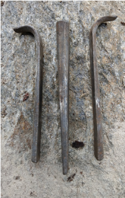
Abbildung 40: Eine Spaltkeilgarnitur besteht aus einem Stahlkeil und 2 Gleitspangen. Die Gleitspangen werden in das vorgefertigte Bohrloch geschoben und dann der Treibkeil mit dem Hammer eingetrieben. (Foto: C. Piccolruaz)
