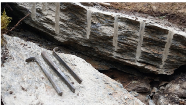
Abbildung 41: Spaltkeile im Vordergrund, gespaltene Gesteinsplatte im Hintergrund. Gut zu sehen die vorgebohrten Löcher mit ca. 10 cm Abstand zueinander. Mit etwas Glück spaltet der Stein genau im Bereich der Keillinie. (Foto: C. Piccolruaz)
