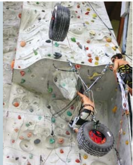
Abb. 6: Aufbau der Messung zum zusätzlichen Energieeintrag bei Ausbruch eines Fixpunkts schematisch und in der Praxis an der Kletterwand
