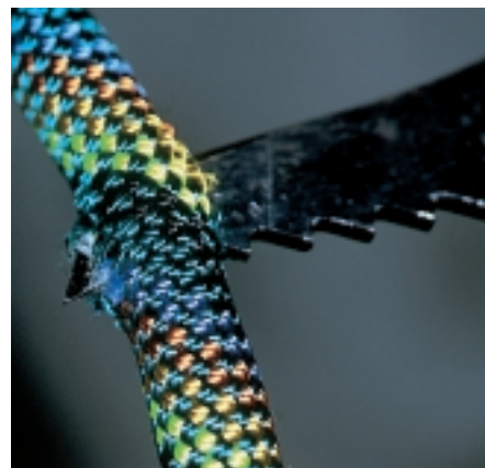
Abb. 14: Seil bewusst mit zusätzlichen Hammerschlägen auf das Eisgerät durchbohrt, bis die Hauenspitze herauschaute, dadurch Schädigung bis 30 Prozent.
