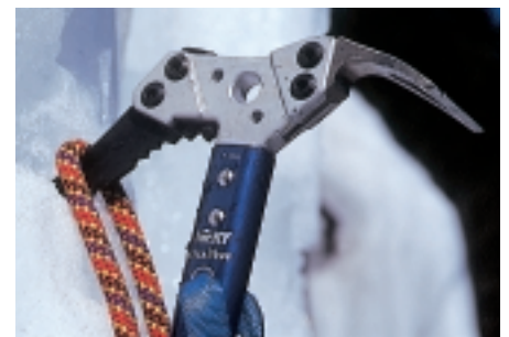
Abb. 11: Hinsichtlich Haltkraft im Eis günstigste Belastung, schadet dem Seil jedoch auf Dauer (nur für „ernste Notfälle“).
