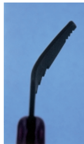
Abb. 6: Beim Belastungsversuch völlig verbogene Haue; kommt in der Praxis nicht vor, weil die Belastungen bei Fortbewegung und Selbstsicherung am Standplatz erheblich niedriger sind.
