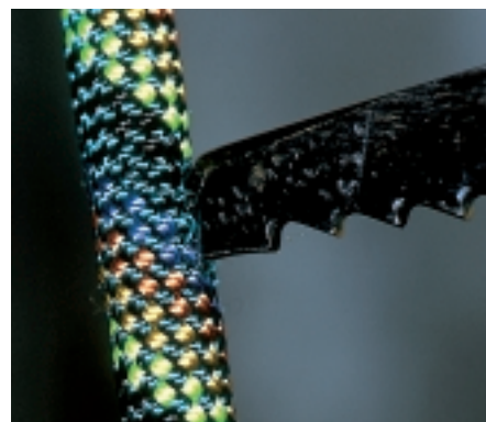
Abb. 13: Seil mit einem Schlag aufgespießt, was dem Seil nicht ernstlich schadet.
