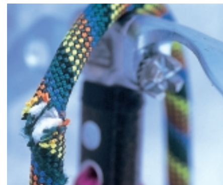
Abb. 15: Scharfe Halbrundhauen sind gefährlich – ein einziger Schlag und das Seil ist mehr oder weniger völlig durchtrennt.
