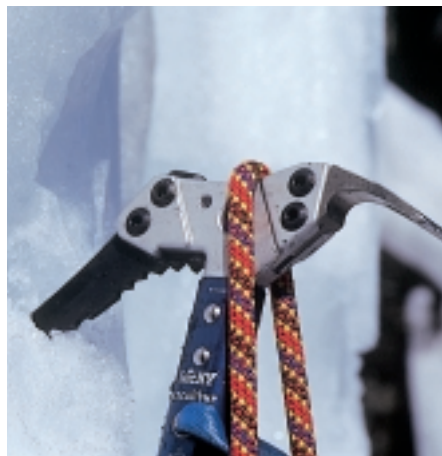
Abb. 10: Auch andere Geräte eignen sich als „schnelle“ Zwischensicherung, wenn der Kopf keine scharfen Kanten aufweist und das Seil rückwärtig nicht herunterrutschen kann.
