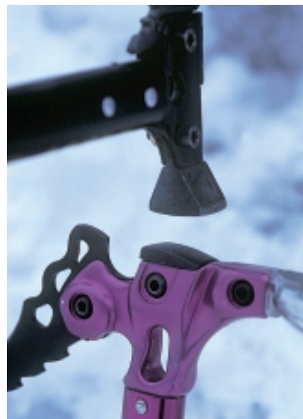
Abb. 12: Das Alien-Gerät von DMM beim senkrechten Eintreiben in Firn (nur mit diesem Gerät sinnvoll, bei anderen Geräten Beschädigung des Kopfes).
