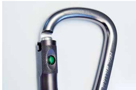
Abb. 2: Verschluss öfter kontrollieren! Ein nicht schließender Ball-Lock ist kein Safelock-Karabiner mehr.
