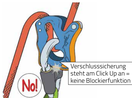
Abb. 3: Bei Sicherungsgeräten Hersteller-Empfehlungen beachten, damit's funktioniert.
