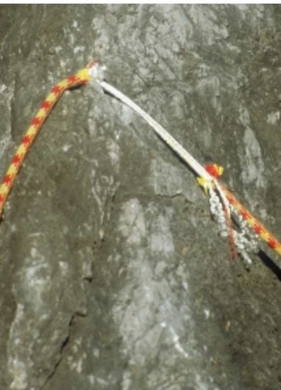
Abb. 3: Sturzbelastung über eine Felskante (Scharfkanteneinfluss) ist sehr gefährlich, aber auch äußerst selten.
