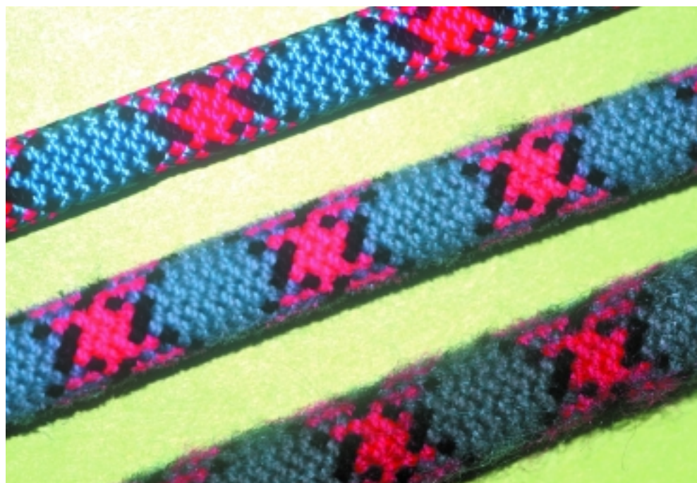
Abb. 1: Ausschnitte der Seile – unbenutztes Referenzseil (oben), im Kalk benutzt (Mitte), im Elbsandstein verwendet (unten); deutlich ist die Zunahme des Durchmessers zu erkennen, die – nebenbei bemerkt – eine Verkürzung der Seillänge von bis zu 10 Prozent zur Folge hat.
