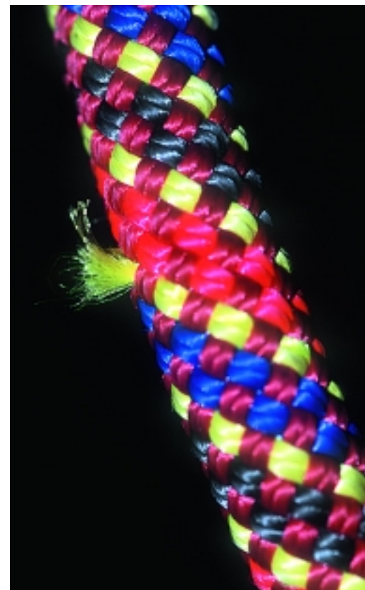
Abb. 4/5: Harmlose Mantelbeschädigung – die Fasern am besten mit einer Nagelschere abschneiden.
