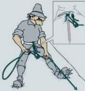
Abb. 2a: „Modifizierter Rammpickel“ in Sitzposition: flottes Provisorium für einen Nachsteiger
