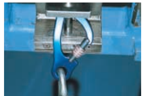
2: Verschluss des Karabiners wird aufgedrückt
