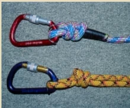
Abb. 3: Nicht wirklich festgezogene Knoten werden von Herstellern oft geliefert (das Abtappen oben ist keine Lösung, die das „selbsttätige“ Knotenöffnen verhindern kann); unten ein „steinharder“ Knoten, der sich nicht mehr lösen kann.
