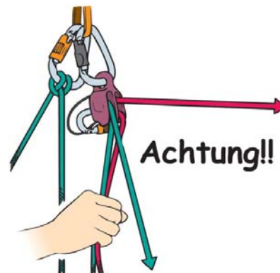
Abbildung 2: Achtung!! Bei großem Winkel zwischen den Seilen blockiert die Platte nicht selbständig
