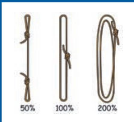
Abb. 2: Faustformel zur Abnahme der Schlingen-Festigkeiten durch Knoten
