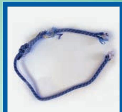
Abb. 1: Als Umlenkung verwendete durchgebrannte Unfallschlinge
