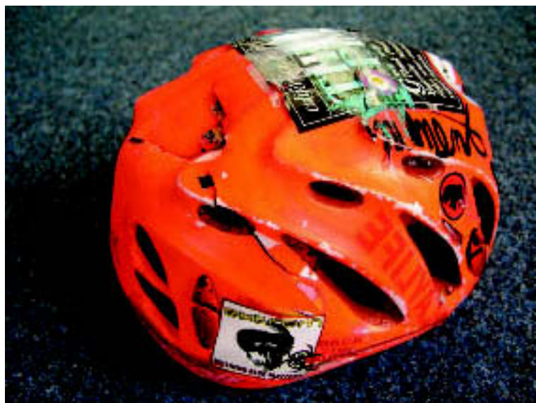
Der Helm des an der Martinswand von Steinschlag getroffenen Kletterers.
