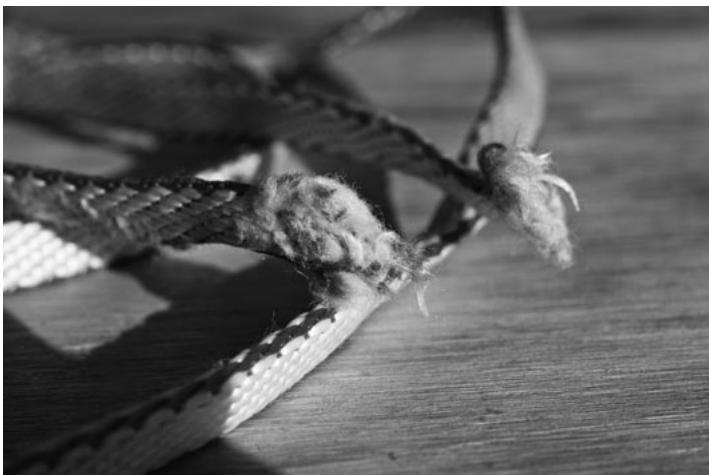
Im Ankerstich gerissene Schlinge. An dieser zum ersten Mal verwendeten Schlinge konnten noch weitere Beschädigungen durch Aufscheuern festgestellt werden Foto: O. Fuchs
