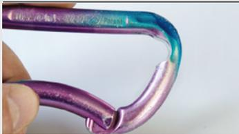
Alle Stähle, noch mehr aber Aluminium, sind anfällig auf Materialabtrag durch Einschleifen. Scharfe Kanten können zu Seilrissen führen. Die Querschnittsminderung bei Alukarabinern ist ab 25 Prozent bedenklich, bei Umlenkern aus Stahl ab ca. 50 Prozent. Vorsicht auch vor Funktionsbeeinträchtigungen durch Einschleifen (z. B. Sicherungsgeräte)!
