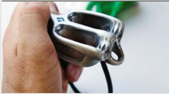
Je mehr die Bremsrillen bei Tubes abgeschliffen sind, desto niedriger ist die Bremswirkung des Tubes und umso höher ist die Anforderung an die Handkraft des oder der Sichernden.
