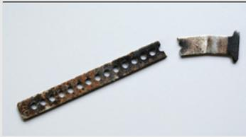
Typischer Ermüdungsbruch des Mittelstegs bei Steigeisen: Das Steigeisen wurde mit einem weichen Schuh zum Gletschertrekking verwendet. Viele Steigeisen haben zwei Befestigungspunkte für den Mittelsteg je nach Anwendung (flexibel: Gehen mit weicher Sohle; starr: Klettern mit steifer Sohle).
