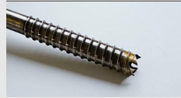
Flugrost ist kein ernsthafter Grund zur Aussonderung; er kann mit einem Scheuerschwamm problemlos wieder entfernt werden.
