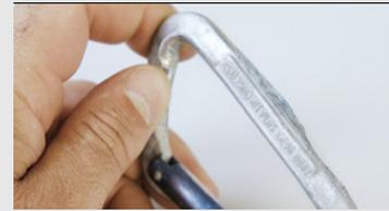
Durch Kontaktkorrosion zwischen dem Aluminiumkarabiner und dem Bohrhaken löste sich diese Fixex am Schleierwasserfall sprichwörtlich auf.
